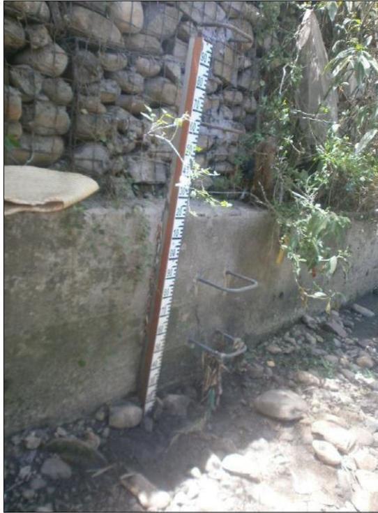
**Figura 2.** Estación limnimétrica
