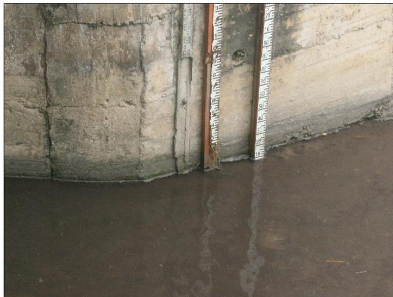
**Figura 3.** Estación Limnimétrica
