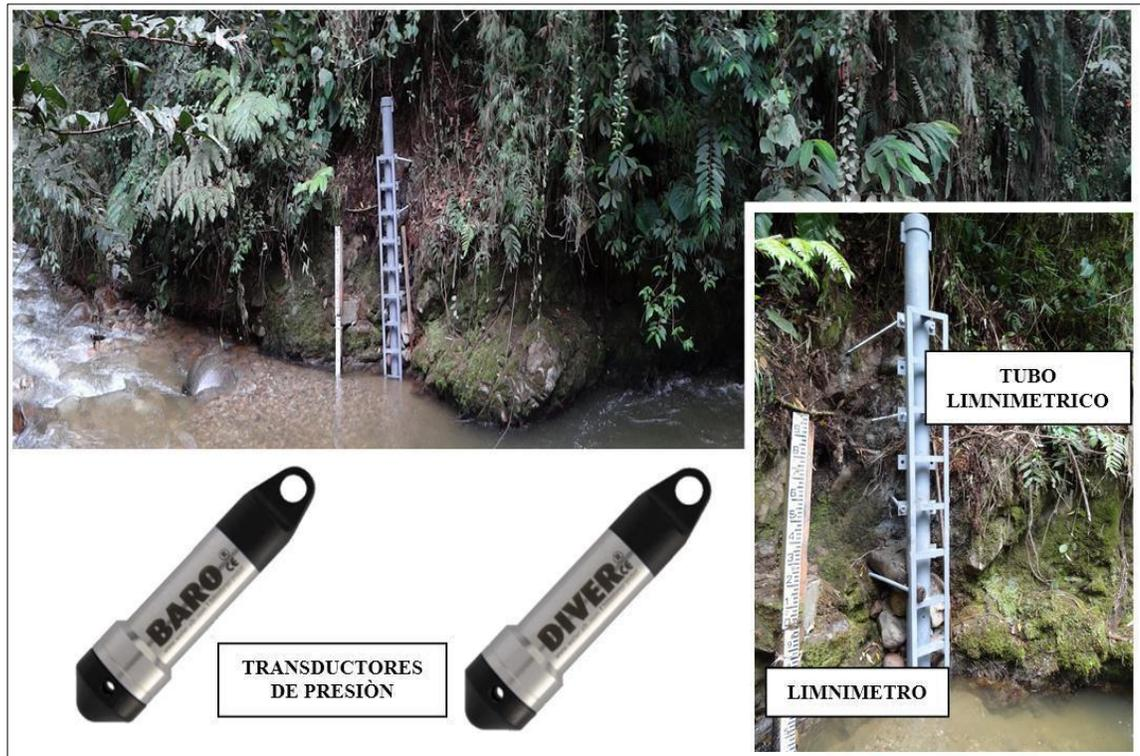
**Figura 4.** Estación automática de niveles El Rasgón
