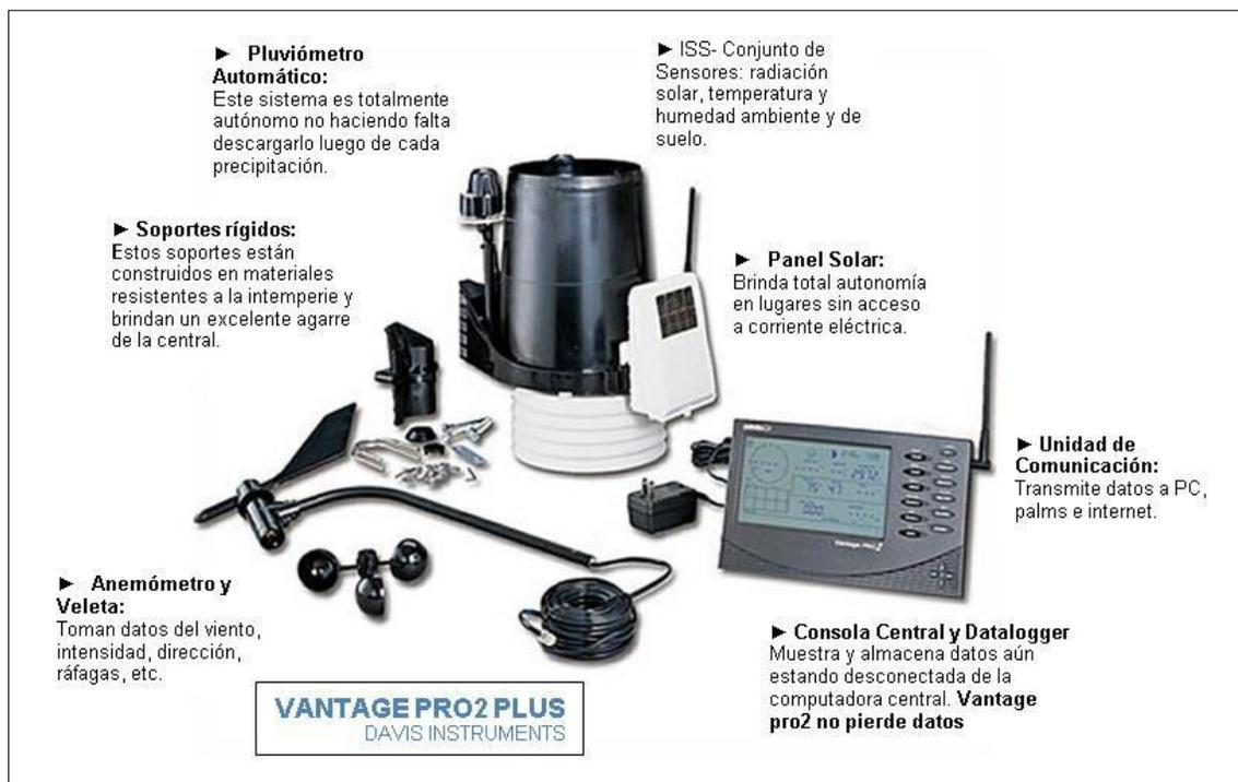
**Figura 1.** Estación climatológica Tipo. (Fuente: Davis Instruments)
